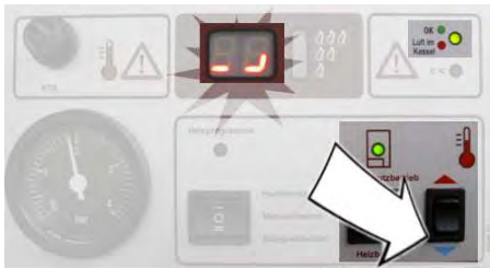
Bild: Temperaturwahltaster drücken
