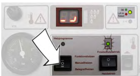
Bild: Programmwahlschalter auf „0“ stellen
