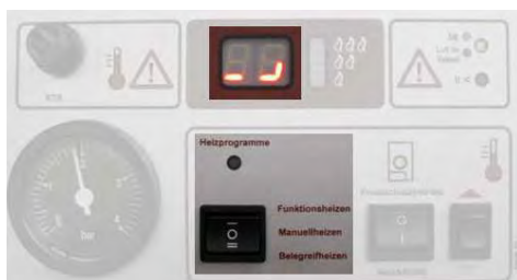
Bild: Bedienfeld Programmschalter manuelles Heizen und Estrichtrocknen Display
